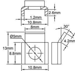
Cavalier pour vis M4 avec protection anti-cisaillement, trou de 5mm, se monte sur les bornes des blocs de jonction en céramique des séries BCA, BCB ; Incompatible avec les séries BCC.
