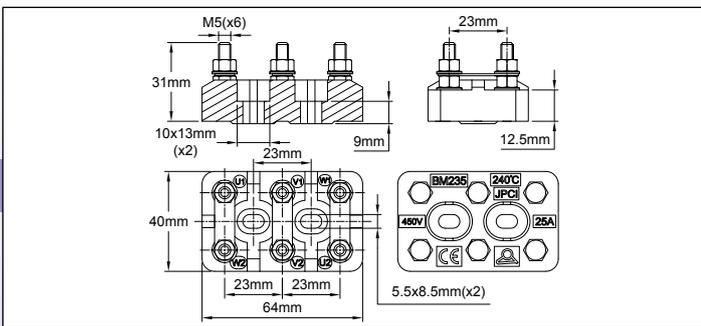
**Modèle 25A 450V (entre axe 23mm, bornes M5)**
