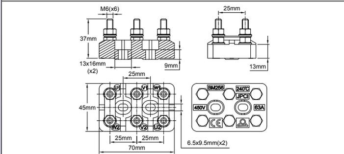
**Modèle 63A 450V (entre axe 25mm, bornes M6)**
