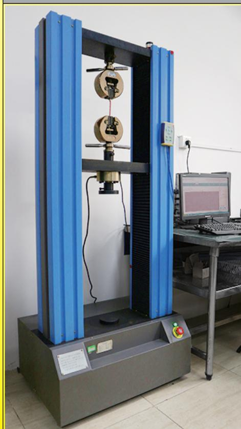
Machine d'essai de force d'arrachement
