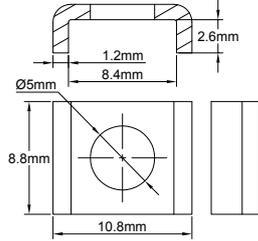
Cavalier pour vis M4, trou de 5mm, se monte sur les bornes des blocs de jonction céramique des séries BCA, BCB et BCC.
