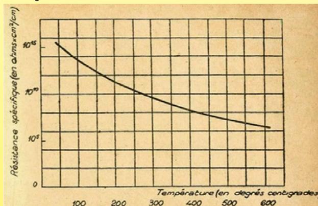
Variation de la résistance spécifique en ohms.cm<sup>2</sup>/cm de la porcelaine en fonction de la température (courbe logarithmique). Entre 20°C et 300°C sa résistivité est divisée par 10.000 (1945 Matériaux électrotechniques modernes, Musée Ultimeat)
