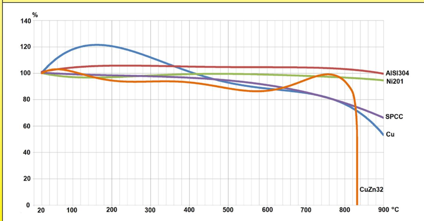
Le cuivre et l'acier perdent progressivement leur résistance mécanique pour n'en conserver qu'environ 50% vers 900°C. Le laiton reste relativement stable mais atteint son point de fusion peu avant 900°C . L'acier inoxydable 304 et le nickel 201 ne montrent pas de variation notable de leur résistance mécanique jusqu'à 900°C
