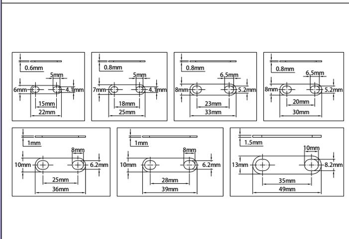
**Shunts en laiton pour borniers de moteurs**
