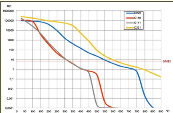
Courbes de variation de résistance d'isolement de borniers en fonction de la température, réalisées dans différents types de céramique, (C110, C111, C220, C221), en épaisseur 2mm. La valeur de 5MΩ est la limite normative.
