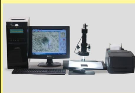
Mesure électronique au microscope du diamètre de l'indentation (Laboratoire Ultimheat)
